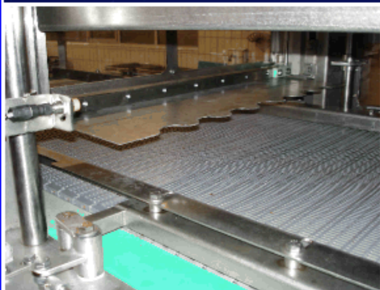
Formatblech zum Zurückhalten nachfolgender Gefäße
